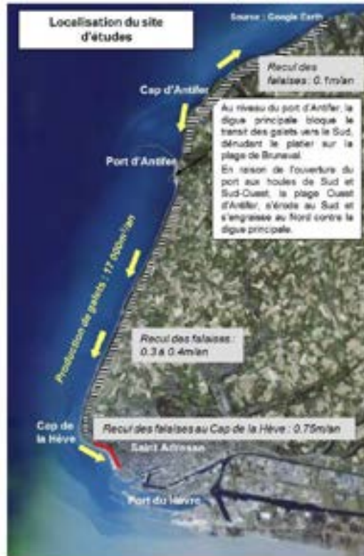
Figure 9 : Schéma du contexte hydro-sédimentaire de la zone d'étude (SOGREAH, 2007)
