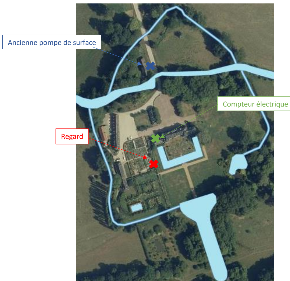
Figure 3 : Localisation du nouveau système de pompage
