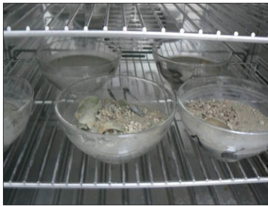
Figure 5 : Echantillons granulométriques à l'étuve à 60°C pendant 48h (Source : TBM)
