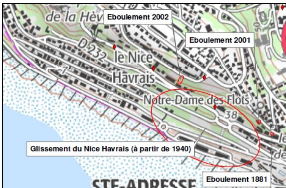
Illustration 1: Extrait de la carte des phénomènes historiques (SCAN 25© - © IGN Paris – Reproduction interdite)
