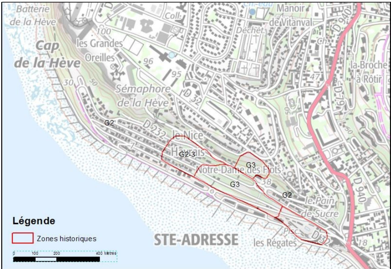
Figure 19: zonage des glissements actifs connus (source Sinelle et Blivet)
