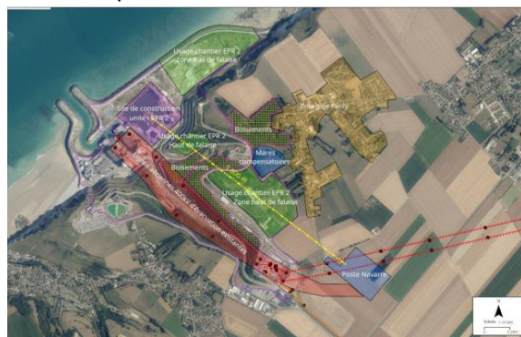
Figure 4 : Vue aérienne de la zone d'étude du raccordement et de ses principales contraintes pour la mise en œuvre d'ouvrages de transport d'électricité.
