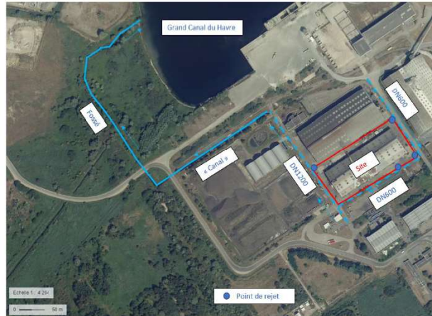
Figure 22 : Principe de rejet au Grand Canal du Havre
