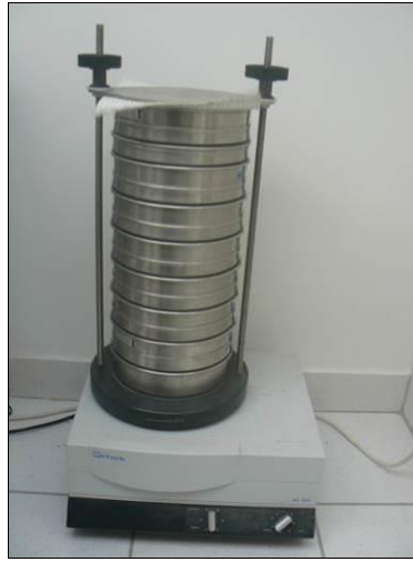
Figure 4 : Colonne de tamis (Source : TBM)
