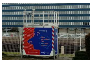
Figure 5 : Station de mesures temporaires - Source : Atmo Normandie
