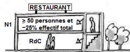
Si N1 ≥ 50 personnes ET Si l'effectif de l'étage < 25% de l'effectif total PAS D'ASCENSEUR OBLIGATOIRE
