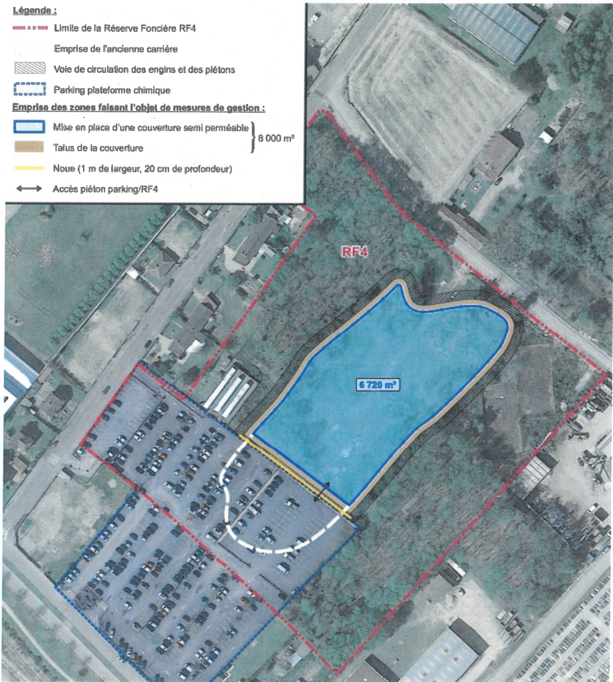
Zone couverte sur le site RF4
