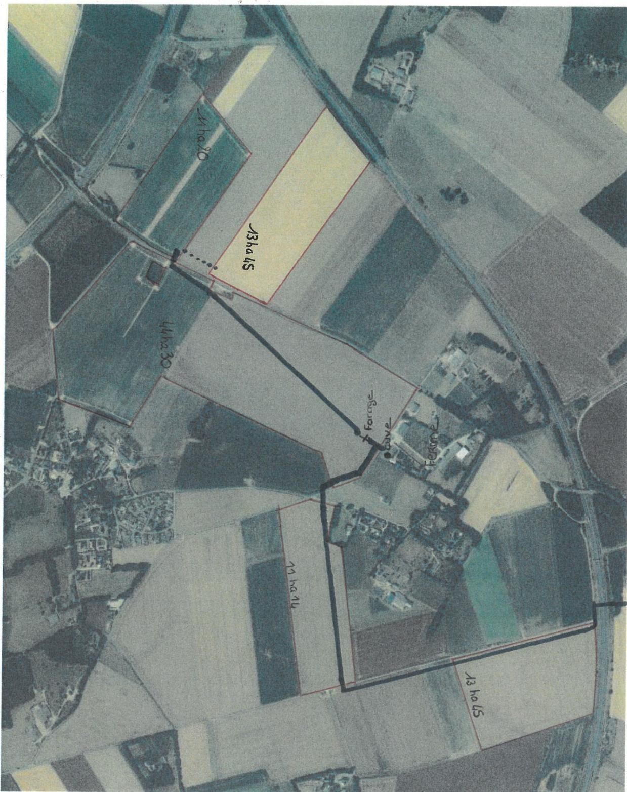
——— réseau d'irrigation enterré Ø 160
