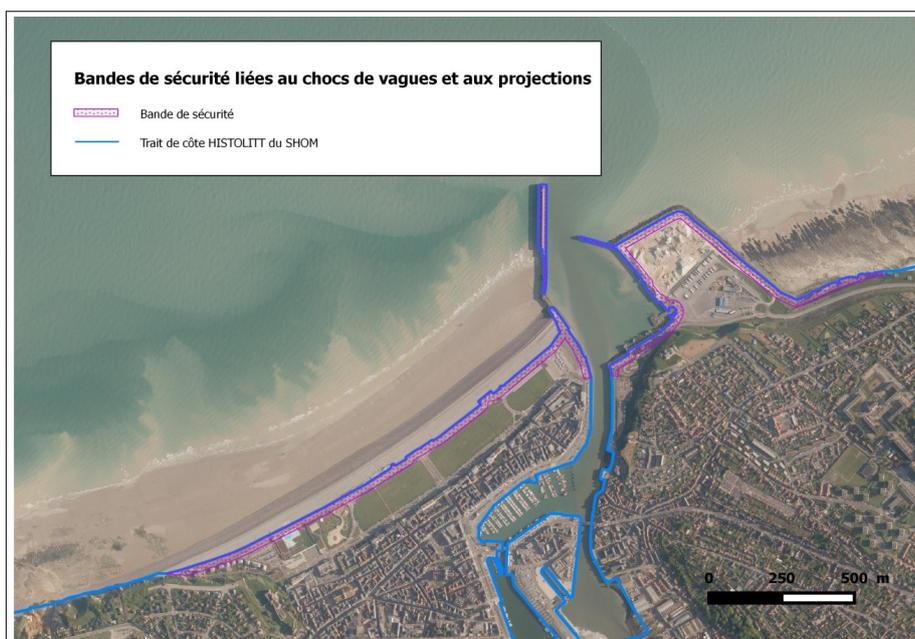
Figure 97: Bandes de sécurité (chocs mécaniques des vagues et projections) au niveau de la grande plage et du port de Dieppe
