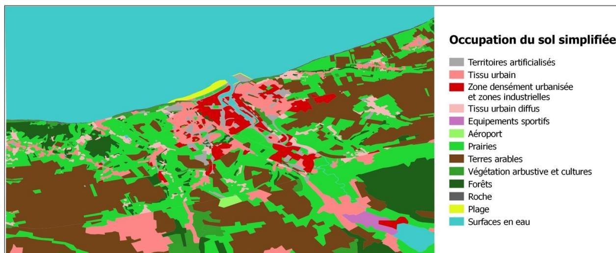
Figure 60: Carte de la typologie simplifiée de l'occupation du sol pour l'établissement de la carte de rugosité
