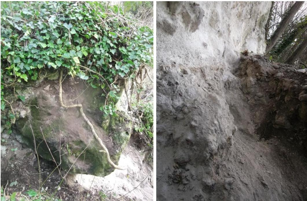
**Figure 6 :** Vue du bloc déchaussé de 8 m<sup>3</sup> et de son assise de craie argileuse altérée
